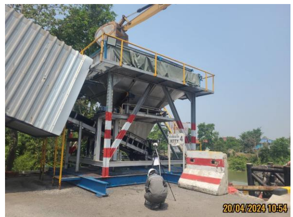
รูปที่ 4.2-38 แสดงการตรวจวัดค่าความทึบของฝุ่นละออง (Opacity) ทำเทียบเรือที่ 4 ห่างจาก Hopper 1 เมตร วันที่ 20 เมษายน 2567
