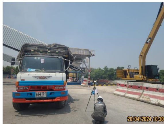
รูปที่ 4.2-37 แสดงการตรวจวัดค่าความทึบของฝุ่นละออง (Opacity) ทำเทียบเรือที่ 3 ห่างจาก Hopper 1 เมตร วันที่ 20 เมษายน 2567
