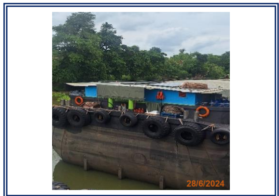
รูปที่ 3-48 อุปกรณ์ความปลอดภัยบนเรือลำเลียงสินค้า
