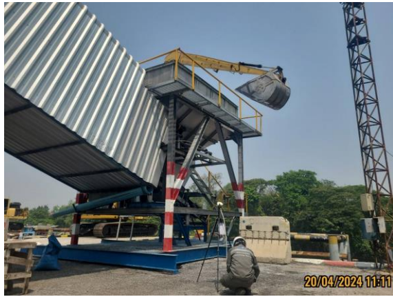
รูปที่ 4.2-35 แสดงการตรวจวัดค่าความทึบของฝุ่นละออง (Opacity) ทำเทียบเรือที่ 1 ห่างจาก Hopper 1 เมตร วันที่ 20 เมษายน 2567
