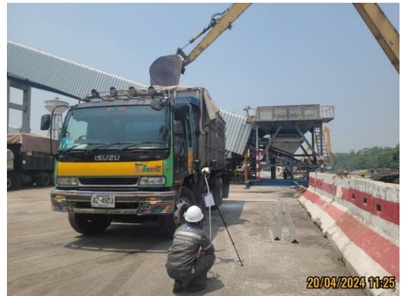
รูปที่ 4.2-36 แสดงการตรวจวัดค่าความทึบของฝุ่นละออง (Opacity) ทำเทียบเรือที่ 2 ห่างจาก Hopper 1 เมตร วันที่ 20 เมษายน 2567
